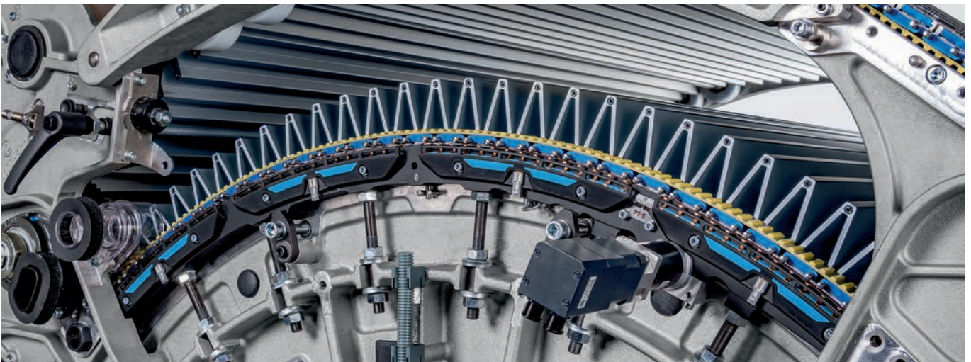
Gap Optimizer T-GO ile TC 19i, kalite ve verimlilikte önemli sıçramalar sağlar, bu şekilde karde bandının kilogramı başına enerji gereksinimi azalır
